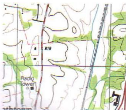
23.22 Las curvas de nivel de un mapa topográfico son curvas de elevación constante y, por tanto, de energía potencial gravitatoria constante.
